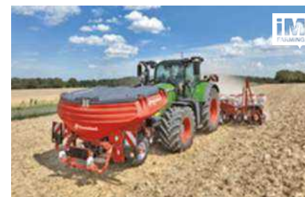
Фронтальный бункер f-drill и сошниковый брус f-drill CB F Управляемые ISOBUS фронтальные бункеры f-drill compact (1600 л) или f-drill maxi (2200 л) с одним дозирующим устройством ELDOS или двумя в исполнении duo или plus обеспечивают высокую норму внесения. Модель f-drill maxi plus позволяет вносить два продукта за один проход. Это настоящий помощник в сочетании с полосовой обработкой почвы, культиватором, короткой дисковой бороней, прополкой, сошниковой бороней или сеялкой точного высева. В комбинации с ними он обеспечивает равномерный баланс веса и максимальную гибкость.
