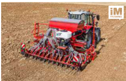
Пневматическая навесная сеялка e-drill maxi plus Посев и внесение удобрений за один проход. Вместимость бункера макс. 2.100 литров делится на регулируемое соотношение 60:40, 70:30 или 100:0. С двумя независимо работающими высевными аппаратами ELDOS с обеих сторон.
