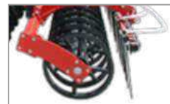
Actipress Single ø560 мм - 140 кг/м (до 175 кг/м с почвой)
