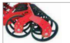
Actipress Twin ø560 мм - 220 кг/м (до 250 кг/м с почвой)
