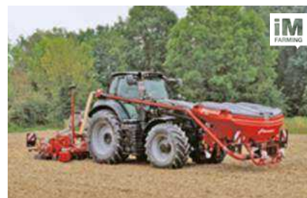
Фронтальный бункер f-drill и сошниковый брус f-drill CB F Управляемые ISOBUS фронтальные бункеры f-drill compact (1600 л) или f-drill maxi (2200 л) с одним дозирующим устройством ELDOS или двумя в исполнении duo или plus обеспечивают высокую норму внесения. Модель f-drill maxi plus позволяет вносить два продукта за один проход. Это настоящий помощник в сочетании с полосовой обработкой почвы, культиватором, короткой дисковой бороней, прополкой, сошниковой бороней или сеялкой точного высева. В комбинации с ними он обеспечивает равномерный баланс веса и максимальную гибкость.
