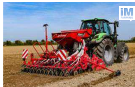
Пневматическая навесная сеялка s-drill S-Drill является сверхмощной версией DA. Это высокопроизводительная машина для крупных хозяйств.
